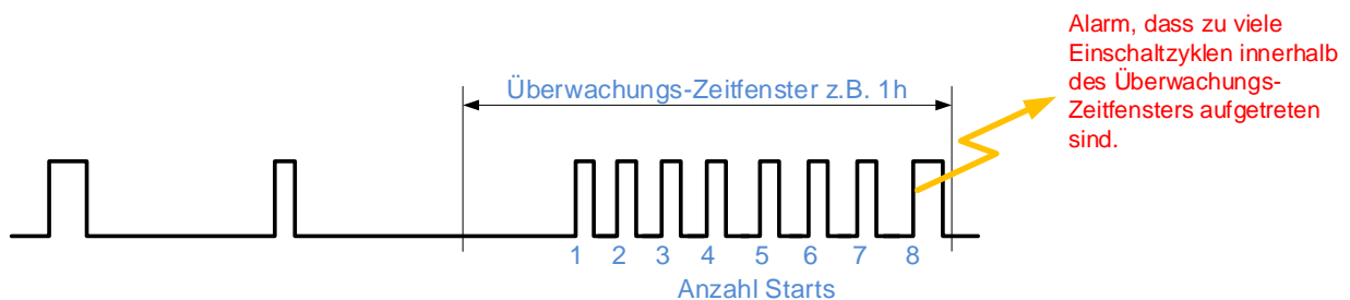
Abbildung 34: Funktion Predictive Maintenance bzw. Überwachung der Einschaltzyklen
